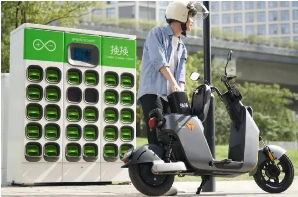
图 3-19 电动自行车换电站
